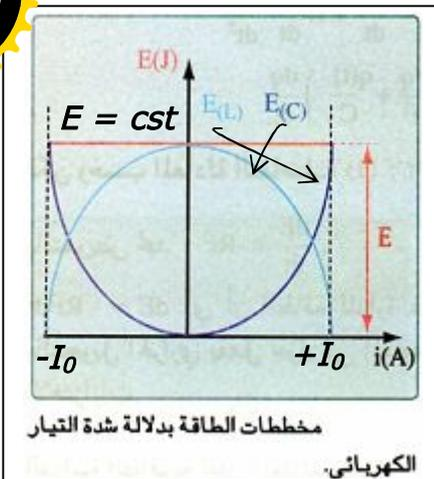
مخططات الطاقة بدلالة شدة التيار الكهربائي في الدارة المثالية (L, C) :
