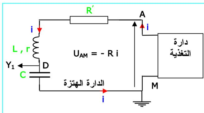
2 - 4 - تغذية الاهتزازات الكهربائية بتعويض التخامد :
